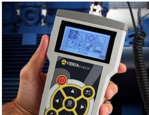
**MAINTraq** es el software modular para Windows que maneja toda la información relacionada con el estado de funcionamiento de las máquinas adquirido con el colector de datos Vibracheck.
